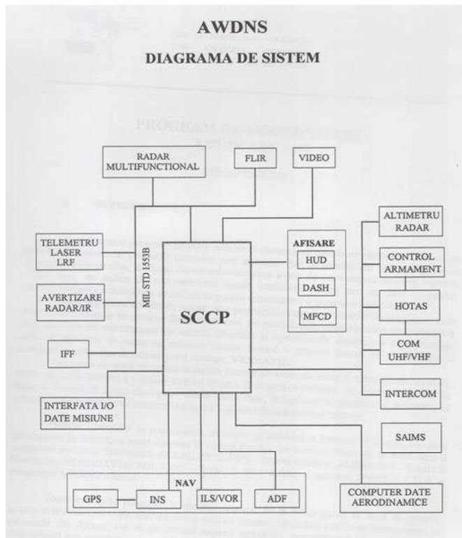
Fig. 2 CENTRAL SYSTEM FOR MISSION CONTROL
